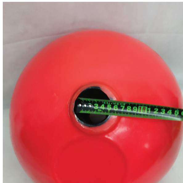
รูร้อยเชือกเส้นผ่านศูนย์กลาง \varnothing 5 cm.
