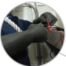
Class 00 แรงดันไฟฟ้าใช้งาน AC : 500V ผ่านการทดสอบ AC : 2,500V
