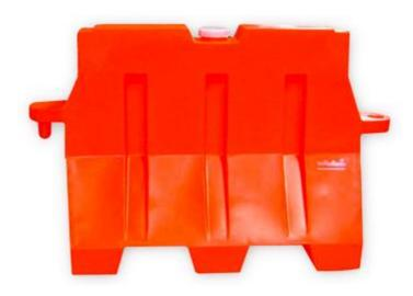
พลิตจากการหล่อขึ้นรูป พลาสติก หนา 5.5 มม. ใช้สำหรับกันเขตช่อมทามดินรถ แบ่มเขตพื้นที่การทำมาน สร้าม ความเป็นระเบียบเรียบร้อย ในพื้นที่ใช้มาน ส่วนบนมีช่อมใส่น้ำเพื่อให้มีน้ำหนักและมีรูระบายน้ำในตัว จึมหมาะสำหรับในเขต พื้นที่ที่ไม่ต้อมการให้เคลื่อนย้าย
